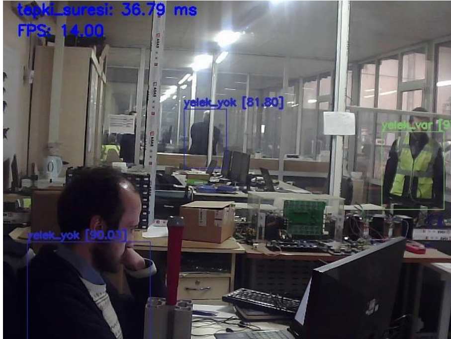
Şekil 9. Ofis ortamında yeke tespit algoritmasının çalıştırılması
