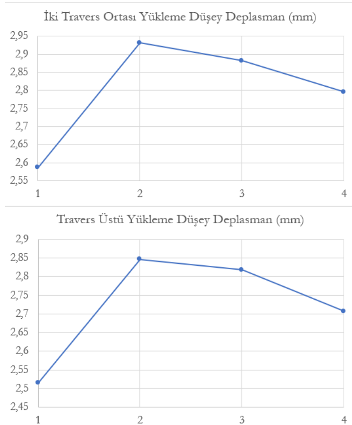
Şekil 3: Yapılan Yükleme Sonucu Oluşan Düşey Deplasman Grafikleri
