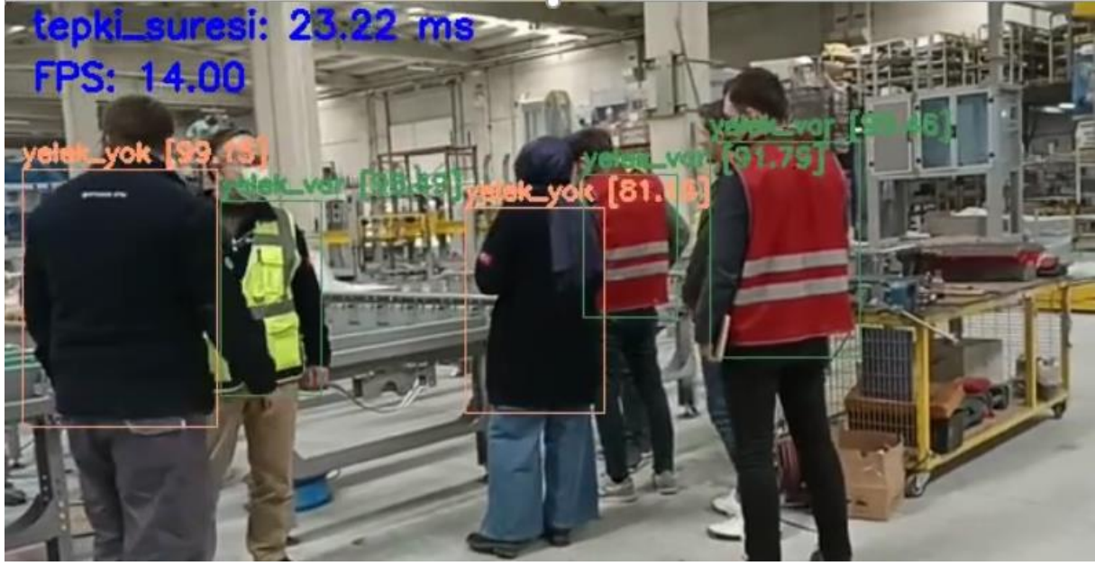
Şekil 10. Sahada yelek tespit algoritmasının çalıştırılması
