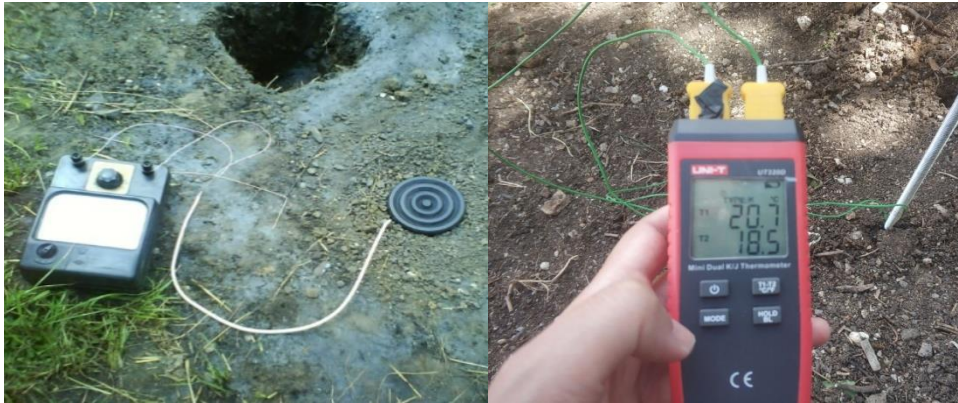
Şekil 5. 29.05.2021 tarihinde 25 cm toprak derinliğinden ölçüm alınan termometre görüntüsü
