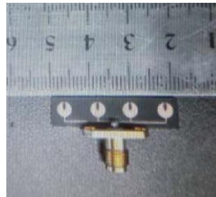
Şekil 14 - Önerilen 1 \times 4 yama anten dizi tasarımı (Khattak vd., 2019:143-144).
