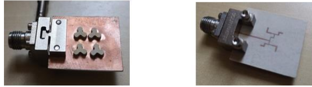
Şekil 5 - Önerilen çiçek şeklinde dielektrik rezonatöre sahip yama anten tasarımı (Kesavan vd., 2021:7-8).
