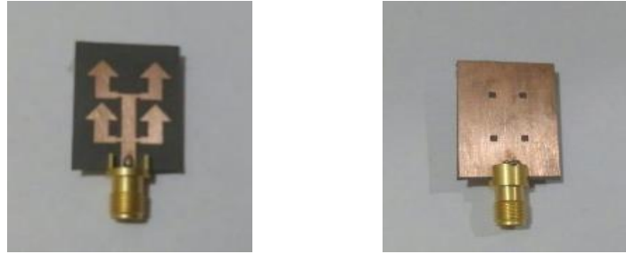
Şekil 17 - Önerilen anten ve DGS yapısı (Sandi vd., 2021: 3-4).
