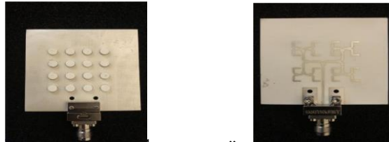
Şekil 6 - Önerilen 16 adet silindirik dielektrik rezonatöre sahip yama anten tasarımı (Niayesh ve Kouki, 2021:8-9).
