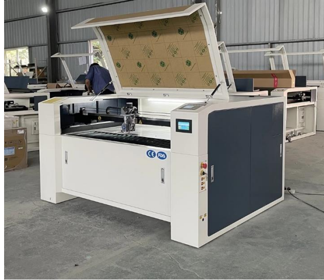
Şekil 1. CO 2 Lazer Kesim makinası
