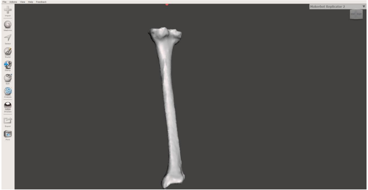
Şekil 5. Autodesk Meshmixer yüzey pürüzlüğü giderme işlemi
