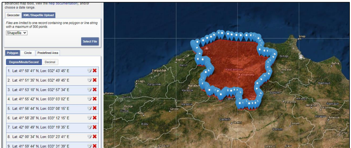
Şekil 4 EarthExplorer'dan uydu görüntüsünün shape file formatı ile indirilmesi
