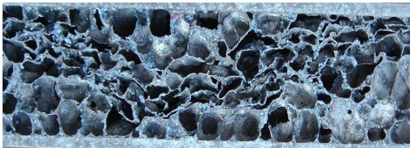
Şekil 4. EDM kesim sonrası köpük alüminyumun yüzey görüntüsü (Sığırtmaç, 2010).
