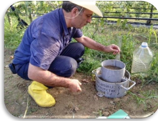
Şekil 3. Çift Silindirli İnfiltrometre ile Su İnfiltrasyonunun Ölçülmesi
