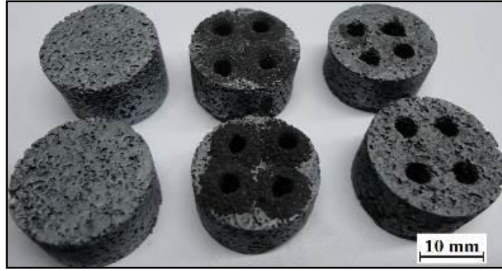
Şekil 9. Delme işleminden önce ve sonra demir esaslı köpük parçalar (Beköz Üllen, 2021).
