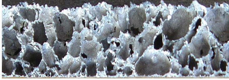
Şekil 6. Lazer kesim sonrası köpük alüminyumun yüzey görüntüsü (Sığırtmaç, 2010).
