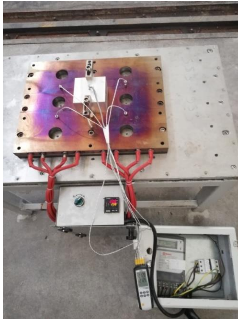
Şekil 3 Rezistanslı Kalıp Isıtma Sistemi
