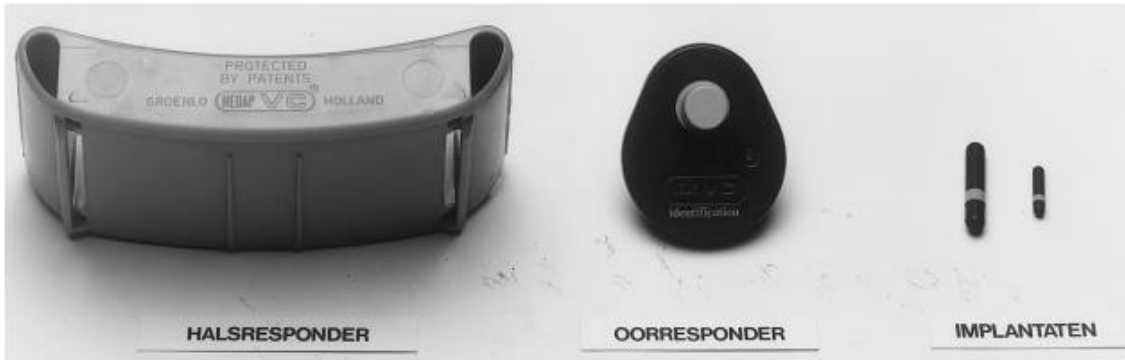
Şekil 1. Boyun tasmalarına takılan ilk transponderler (Taşkın & ark., 2016)
