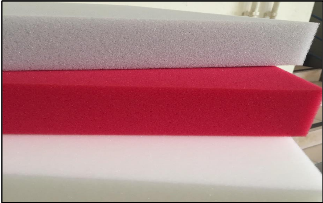
Şekil 3. Farklı yoğunluklarda üretilen esnek poliüretan köpükler (Yıldız, 2019)
