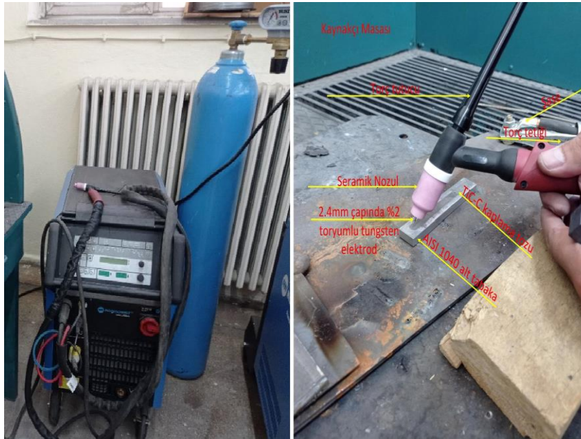
Şekil 3. TIG Kaynak Makinesi ve Kaplaması yapılan Numune
