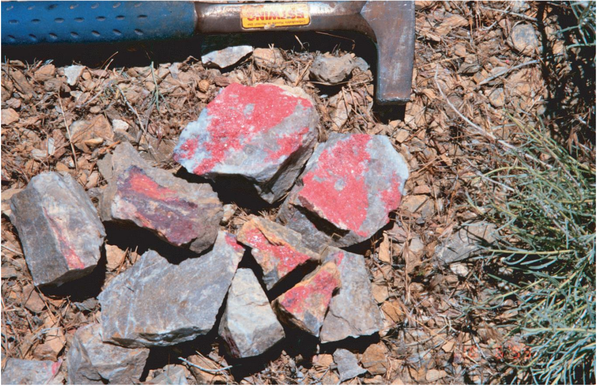
Şekil 3. Dünya çapında Hg madenlerinde en yaygın Hg cevheri olan zinober (kırmızı mineral) örneği (Gray, 2003).
