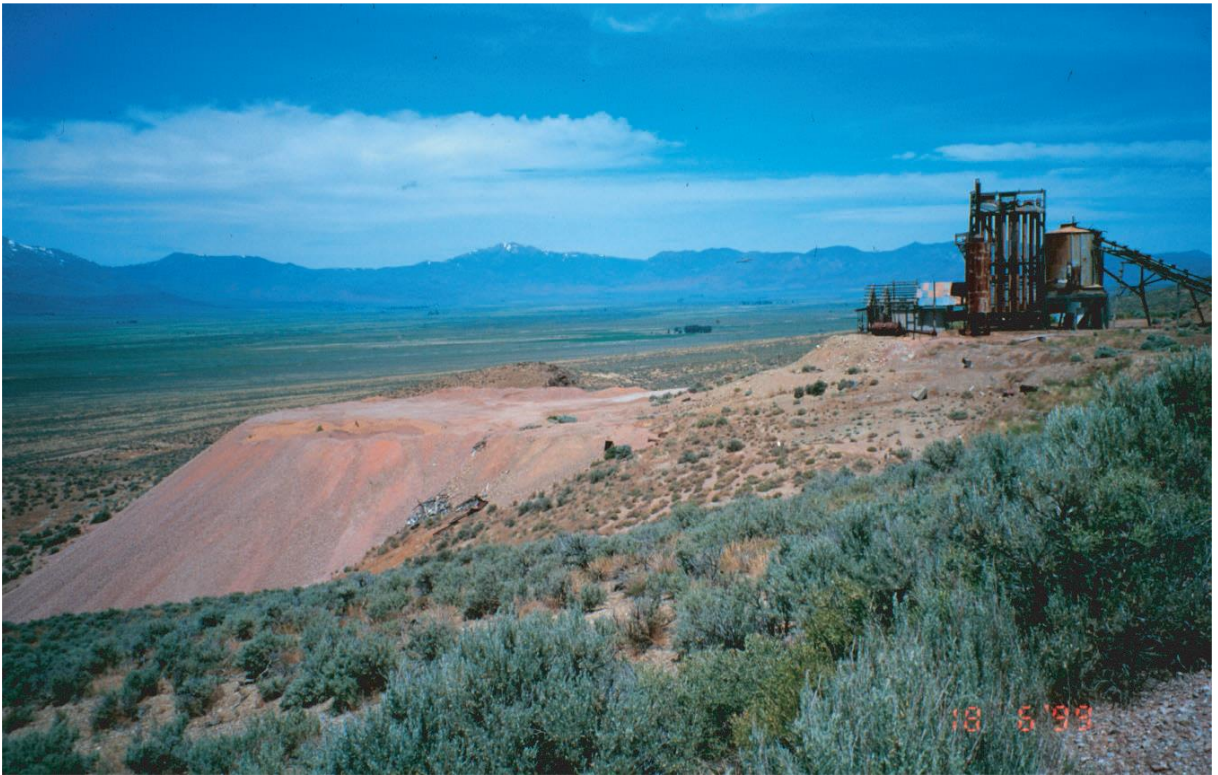
Şekil 4. Nevada'da aktif olmayan Hg madeni. Döner fırında Hg cevheri yakılarak Hg gazı üretiliyor, bu gaz soğutuluyor ve Hg elementi olarak yoğunlaştırılarak toplanmaktadır (Gray, 2003).
