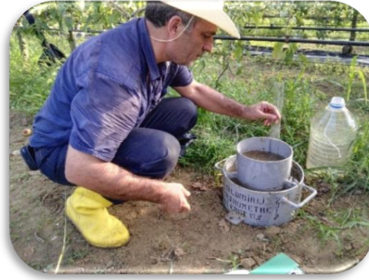
Şekil 3. Çift Silindirli İnfiltrometre ile Su İnfiltrasyonunun Ölçülmesi
