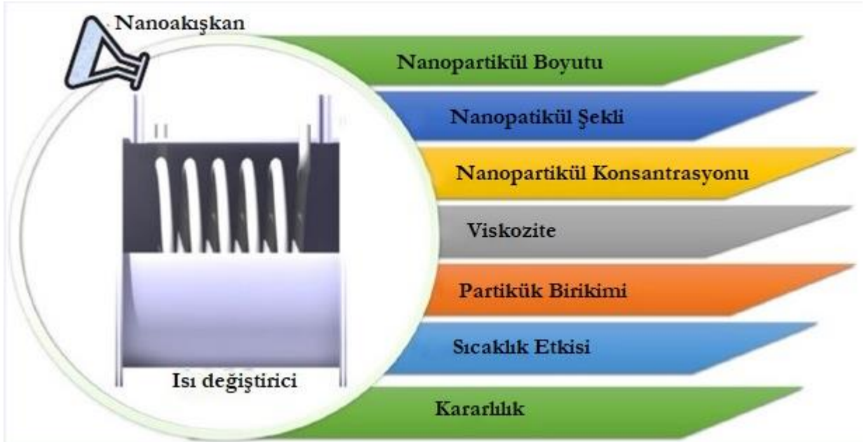
Şekil 2. Nanoakışkanların Isı Transferini Etkileyen Fiziksel Parametreler (Pordanjani A. , ve diğerleri, 2019)
