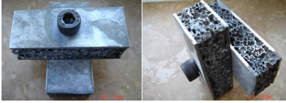
Şekil 8. Delme işlemi sonrası cıvata bağlantısı yapılan alüminyum köpük (Sığırtmaç vd., 2012).
