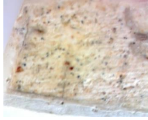
Şekil 11. 3 no.lu numunenin stereo mikroskop altında kalın kesit görüntüsü
