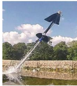
Şekil 1.10. AquaMAV prototipinin jet tahrikli fırlatma anı (Siddall vd., 2017)
