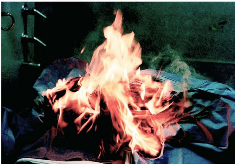
ESU'nun neden olduğu bu yangın simülasyonunda, ESU'dan çıkan bir kıvılcımdan 24 saniye sonra tüm hasta başı ve örtüler alevler içindedi.
