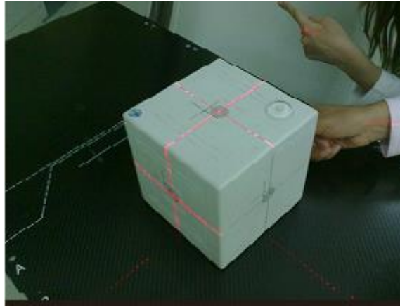
Şekil.3.2.2.1.Özel dizayn edilmiş fantomunun ortogonal lazerlerle set-up'ı (GEAH Radyasyon Onkolojisi)
